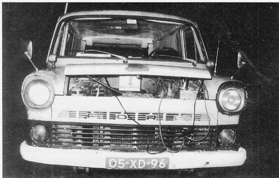
Mobiel uitzenden vanuit een Ford Transit. De voedingskabels voor de zendapparatuur hangen uit de motorruimte.
